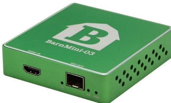
Устройство имеет входной HDMI и выходной SFP порты. Могут использоваться различные оптические SFP MSA модули (на разную дальность и скорость), а также электрические SFP модули, поставляемые как Barnfind, так и сторонними производителями.
