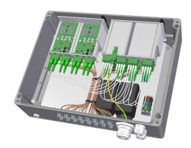
Шасси наружного исполнения DEV 7187 позволяет устанавливать до 4х оптических модулей, то есть до 16 оптических каналов. ВЧ порты (с или без функции резервирования) устанавливаются под оптическими модулями. Кроме того, слот, расположенный над оптическими модулями, может быть оборудован де-мультиплексором CWDM.
