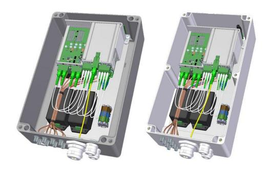
Оба шасси наружного исполнения предназначены для установки до 2х оптических модулей, то есть до 8 оптических каналов. ВЧ порты (с или без функции резервирования) устанавливаются под оптическими модулями. Кроме того, слот, расположенный над оптическими модулями, может быть оборудован де-мультиплексором CWDM.
