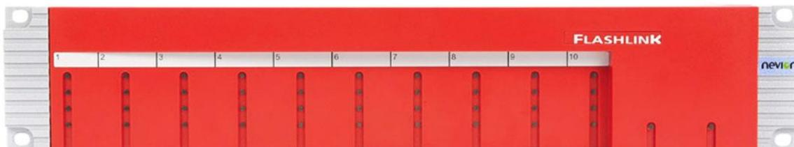
Шасси Flashlink FR-2RU-10-2 выполнено в компактном форм-факторе и может содержать до 10 модулей Flashlink. Высокая надёжность устройства достигается за счёт полного отсутствия в шасси активных компонентов и вентиляторов, а также благодаря возможности установки резервируемых блоков питания (доступны опции с БП постоянного и переменного напряжения).
