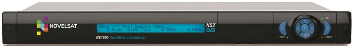
NovelSat NS1000 - это современный модулятор, разработанный на базе высоких требований спутниковой трансляции с возможностью использования стандартов DVB-S/S2/S2X и технологий NS3™ и NS4™.
