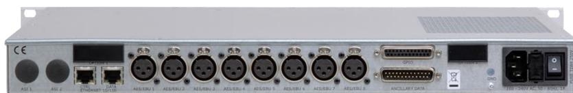
В случае, если требуется закодировать более 8 программ, кодеры могут быть соединены каскадно, что позволяет формировать транспортный поток, содержащий до 40 аудиопрограмм.
