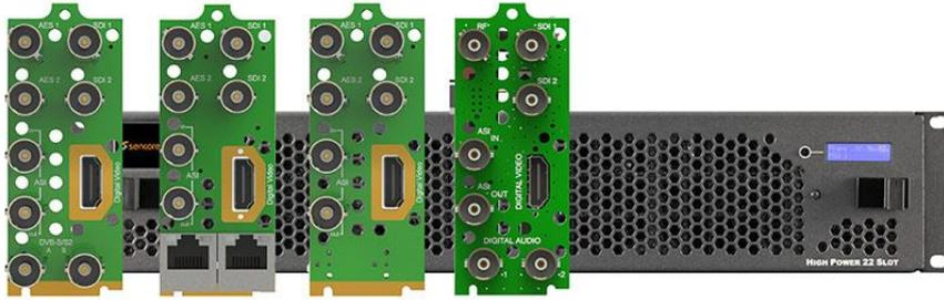
Приемник-декодер Sencore AG5800, выполненный в виде карты для шасси Sencore openGear, представляет собой компактное решение для высококачественного декодирования. Шасси Sencore openGear (19", 2RU) позволяет установить до 10 карт приемников-декодеров AG 5800.
