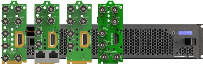
AG 6000 – это новый 4K/UHD приёмник-декодер, выполненный в виде карты для шасси Sencore openGear, построен на новейшей платформе декодирования ASIC 4K/UHD последнего поколения, для обеспечения надежного и экономичного мониторинга и организации дальнейшей обработки контента, вещания в гостиницах, торговых центрах, корпоративного ТВ и рекламы в форматах 4K/UHD.
