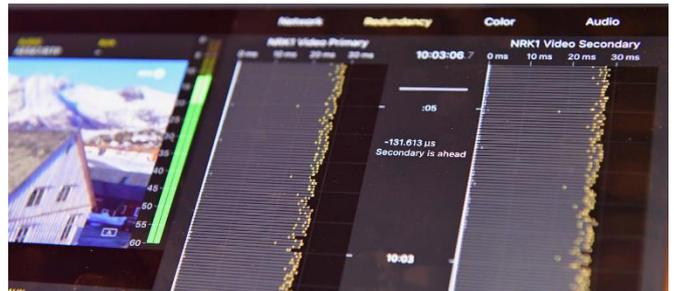
Существует возможность выбора источника в реальном времени с помощью программируемых кнопок быстрого доступа или выбора из любого потока, присутствующего в сети. Контентный мониторинг и анализ, включая колориметрию HDR и многоканальный аудиоанализ, могут выполняться на любой цифровой комбинации видео / аудио с разрешением SD, HD, HD HDR, 4K и 4K HDR и выше. С Instruments View анализатор становится уникальным устройством для анализа видео в IP сети любой архитектуры.
