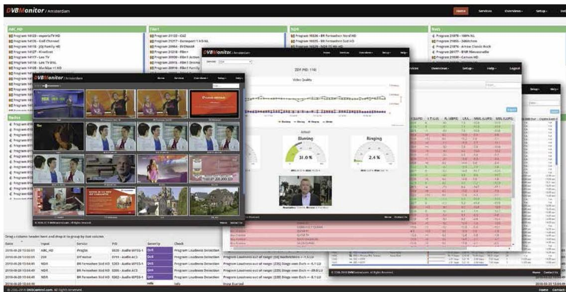
DVBMonitor обеспечивает контроль транспортных потоков в соответствии со стандартом ETR290, а также мониторинг видео/аудио сервисов, данных, временных характеристик SI/PSI, битрейта, и других параметров. Приложение поддерживает контроль нескольких независимых точек сети цифрового ТВ вещания и многопользовательский доступ.
