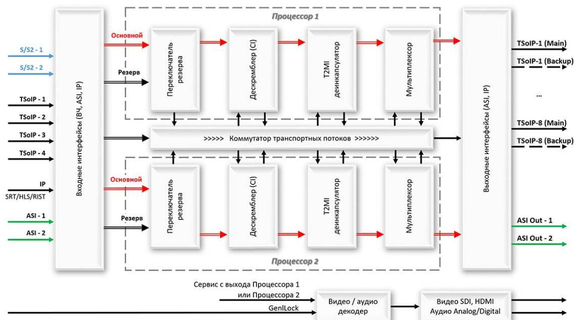
Приёмник ФортФТ FFT 200 имеет гибкую программно-определенную архитектуру на базе самых современных компонентов, что позволяет ему выполнять одновременную многопотоковую обработку транспортных потоков и их гибкую внутреннюю коммутацию. Структурно приемник имеет:
