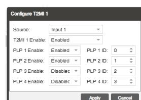
Деинкапсулатор каждого из процессоров поддерживает выделение до четырех PLP из входного T2-MI потока. Далее каждый из выделенных транспортных потоков может быть подан на мультиплексор, декодер или на свой независимый выход ASI (2 выхода) или IP (8 выходов).
