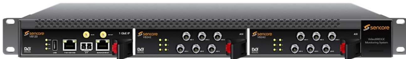
Система, состоящая из базового анализатора Sencore VideoBRIDGE VB120 или VB220 и двух модулей Sencore VideoBRIDGE VB242, установленных в одно шасси Sencore VideoBRIDGE VB200 способна обрабатывать до 13 входных потоков ASI, что делает её незаменимой в случае настройки и/или дистанционного мониторинга сложных головных станций, центров мультиплексирования и других элементов инфраструктуры цифрового ТВ вещания.
