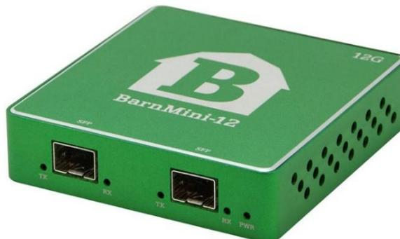
BarnMini-12 поддерживает скорость передачи данных до 12 Гбит / с. Он может обрабатывать 12G и 6G SDI, 10G Ethernet и любой другой цифровой сигнал со скоростью передачи данных ниже 12 Гбит / с. Он оборудован синхронизатором. Как и любой модуль BarnMini, он доступен в виде отдельного модуля с отдельным блоком питания или устанавливается в корпус BarnMini BTF-Mini-16, в котором размещается любая комбинация из 16 модулей BarnMini с общим блоком питания.
