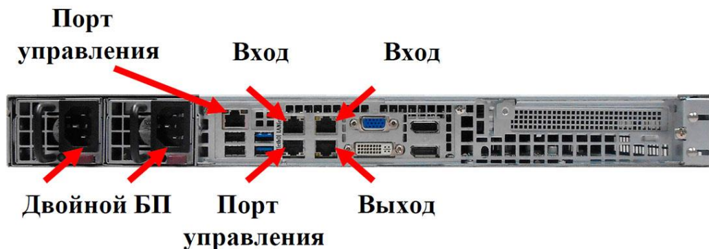
Вид задней панели DVEO StreamWatch IP/5-48
