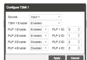
**Мультиплексор** позволяет формировать выходной транспортный поток на основе сервисов, принимаемых со всех входов приемника, с выходов переключателя резерва, с выхода дескремблера и выхода деинкапсулятора. Причем источником входного сигнала мультиплексора могут служить не только компоненты «своего» процессора, но потоки с другого процессора обработки данных.
