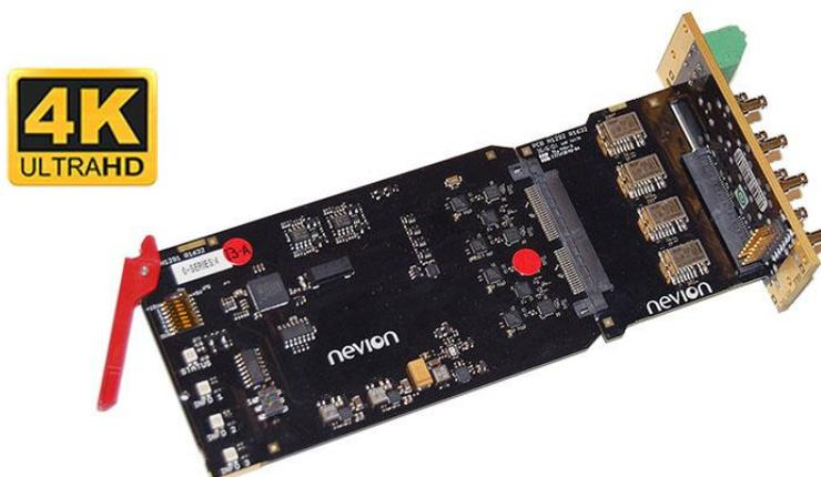
Flashlink QUAD-CHO-2x1-PB представляет собой четырехканальный переключатель резерва 2x1 интерфейсов 3G / HD / SD-SDI с пассивным входным байпасом и хорошо подходит для переключения сигналов UHD / 4K с четырьмя интерфейсами.
