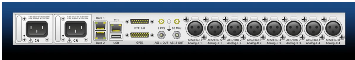
Задняя панель MM08E – профессиональный мультиформатный многоканальный IP/MPEG аудио кодер
