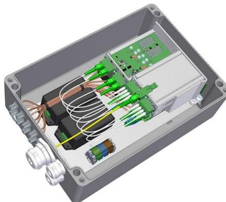
Alpha DEV 7186 - алюминиевое шасси повышенной прочности наружного исполнения для передачи 16 ВЧ сигналов по оптическому волокну. Шасси наружного исполнения DEV 7186 позволяет устанавливать до 2х оптических модулей, то есть до 8 оптических каналов. ВЧ порты (с или без функции резервирования) устанавливаются под оптическими модулями. Кроме того, слот, расположенный над оптическими модулями, может быть оборудован де-мультиплексором CWDM.
