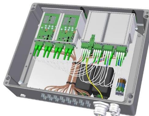
Шасси наружного исполнения DEV 7187 позволяет устанавливать до 4x оптических модулей, то есть до 16 оптических каналов. ВЧ порты (с или без функции резервирования) устанавливаются под оптическими модулями. Кроме того, слот, расположенный над оптическими модулями, может быть оборудован де-мультиплексором CWDM.
