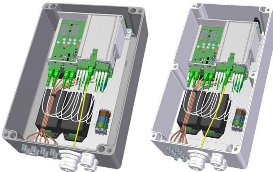
Оба шасси наружного исполнения предназначены для установки до 2x оптических модулей, то есть до 8 оптических каналов. ВЧ порты (с или без функции резервирования) устанавливаются под оптическими модулями. Кроме того, слот, расположенный над оптическими модулями, может быть оборудован де-мультиплексором CWDM.
