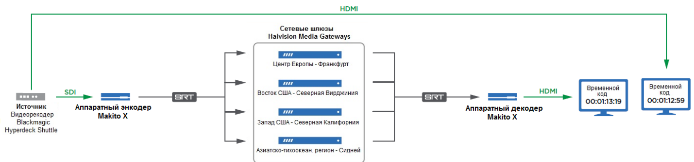
Рисунок 9: Тестовая система с использованием аппаратных энкодеров и декодеров Makito X
